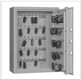
Zur sicheren Verwarung von Autoschlüsseln in kleinen und mittelständischen Betrieben. Diese Tresore sind mit einem Doppelbart-Hochsicherheitsschloss mit 2 Schlüsseln ausgestattet. Die Tür ist doppelwandig (58 mm dick) mit 3-seitiger Verriegelung durch Schließbolzen (20 mm Durchmesser). Die Feuerisolierung wird durch umlaufenden Feuerfalz gewährleistet.
